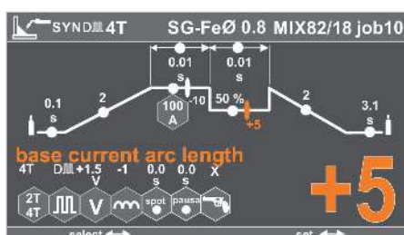
Nastavení sekundárních svař. parametrů / setting the secondary welding parameters
